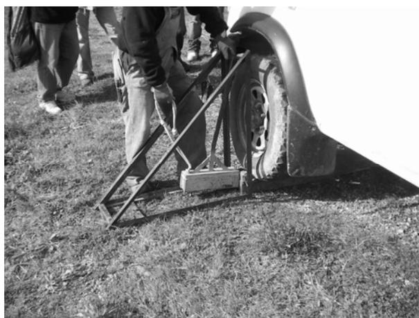
Fig. 4 Energizzazione trasversale con pendolo ad impatto orizzontale (Onde S)
