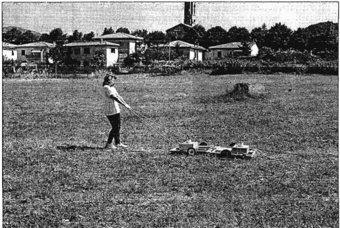
Figura 6. Radar geologico OYO a slitta, durante una prospezione in località Cerbaia (Fi).
