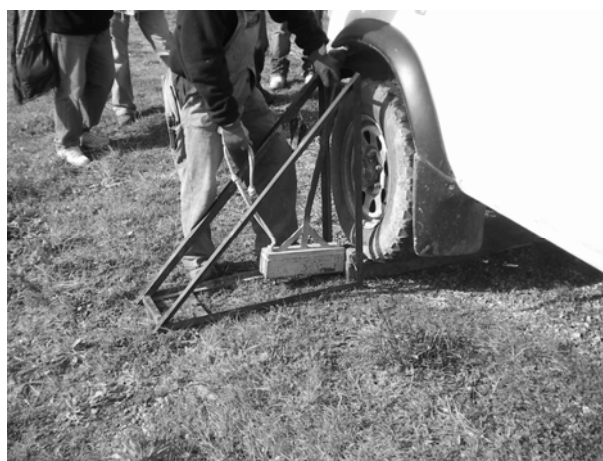
Fig. 4 Energizzazione trasversale con pendolo ad impatto orizzontale (Onde S)
